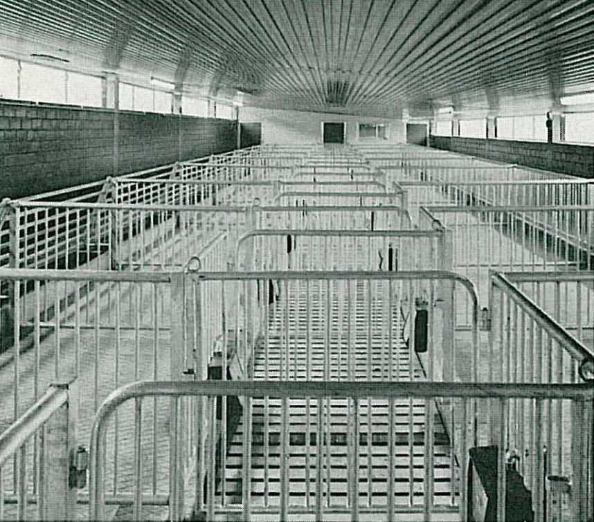
*Schweinemaststall (VI) für 204 Mastschweine, in Gruppenmast-/Trog- und Bodenfütterung möglich. Zentraler Kotgang mit Spaltenboden, Selbsttränken, Zwangsbelüftung mit Warmluftheizung. Stalldecke, Fenster und Türen aus Aluminium.*
