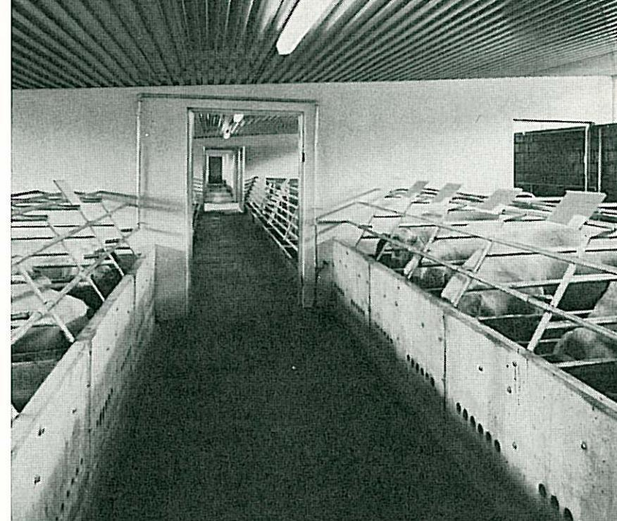
*Blick durch den Schweinezuchtstall (V) für virusfreie Haltung nach dem schwedischen System. Im Vordergrund Einzelaufstallung der Galtsauen. Dahinter Gruppenaufstallung der Zuchtjäger, dann 2 getrennte Abferkelställe. Entmistung in sämtlichen Schweineställen nach dem Kriechmistverfahren.*
